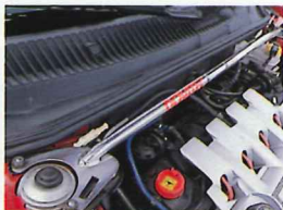
心許ないボディ剛性を高めるタワーバーはオールアルミ製。
