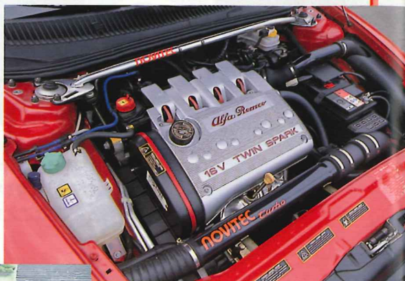
心許ないボディ剛性を高めるタワーバーはオールアルミ製。
